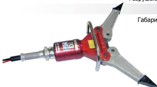
Предназначены для расширения проемов. Гидравлический возврат поршня, гидроснабжение от внешней насосной станции, управление с поста на рукоятке инструмента, рабочее давление 70МПа; малый вес.
