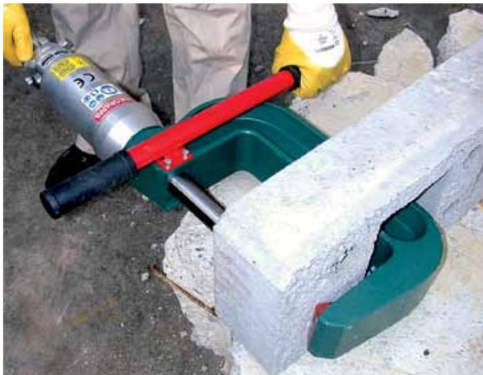
Возможно применение для разрушения железобетонных конструкций через проем размером 250x250 мм.
