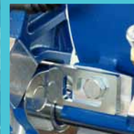
Fermo per fresare da un solo lato Facer stopper allows to continue facing only one side
