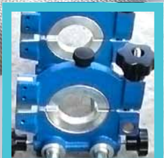
Morse e riduzioni in metallo leggero Light metal clamps and rings
