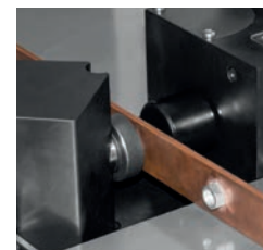
Вдавливание гаек SH 407.
