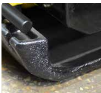
Высокопрочное литое основание
