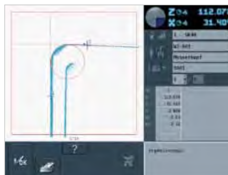
8. Функция »C.R.I.S.« – измерение действительных размеров вращательно-симметричных инструментов. Соответствует размерам без искажений, которые дает инструмент при обработке материала.
