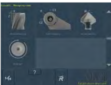
7. Программы измерения, выполняемые системой, с фотореалистичным диалоговым окном ввода, например, самый большой резец на рецзовой головке, concentricity, absence of end face, theoretical tip of drill and pr.
