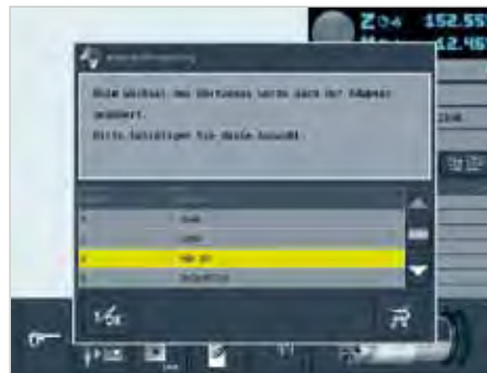
5. Автоматический мониторинг нулевой точки – указание текущей нулевой точки перед каждым измерением. Для предотвращения отказа станков, поломки инструментов и брака деталей.
