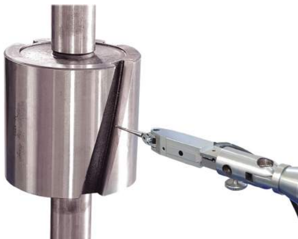
Эталон угла наклона линии зуба
