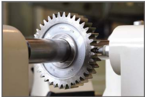
Проверка эталонного зубчатого колеса на приборе 3603А
