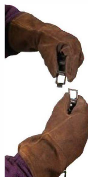
Звенья цепи можно отрегулировать по диаметру труб.
