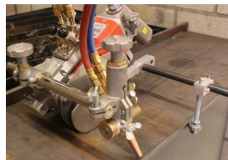
Для резки с краю листа с направляющим роликом
