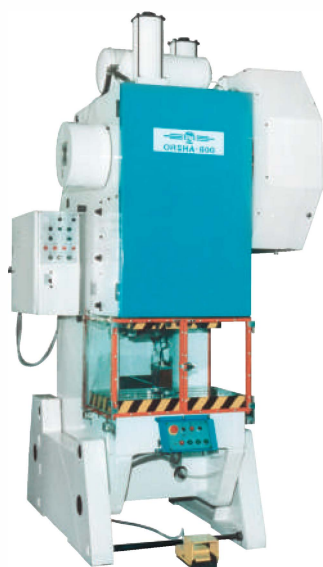
ОРША- 800 (усилие 80т) наклоняемый
