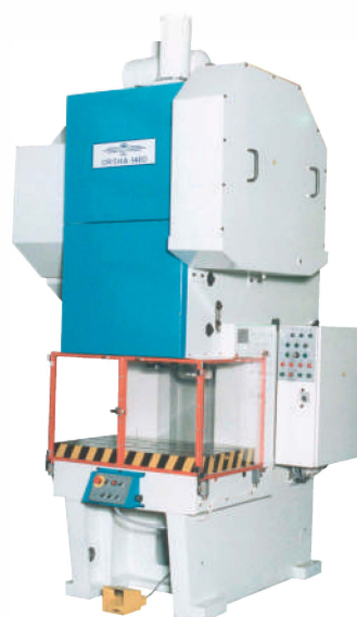
ОРША- 1400 (усилие 140 т) ненаклоняемый
