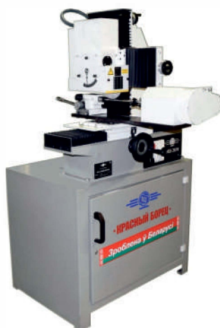
Станок ОШ-2030 с тумбой и приспособлением для круглого шлифования
