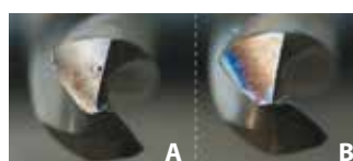
Сверла после обработки 10 отверстий: А) с использованием «ВЖИКа» Б) без использования каких-либо средств
