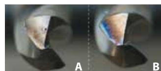
Сверла после обработки 10 отверстий: А) с использованием спрея JET Б) без использования каких-либо средств
