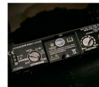
Наивысший класс автоматического затемняющегося светофильтра - 1/1/1/1.
