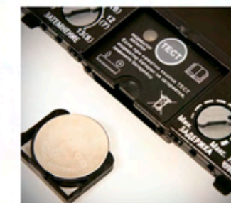
Кнопка «тест» осуществляет проверку работоспособности светофильтра.
