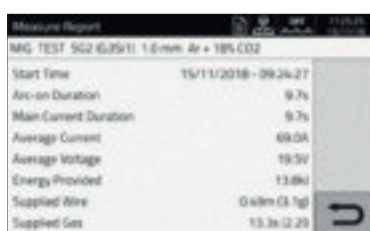
Отчет об измерениях после каждого сварочного прутка
