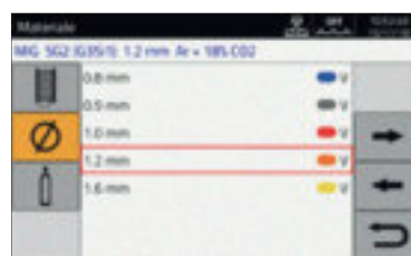
Установка присадочной проволоки с индикацией типа барабана
