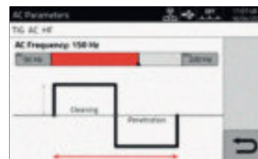
Быстрая регулировка параметров частоты переменного тока (только для аргоно-дуговой сварки на постоянном и переменном токе)
