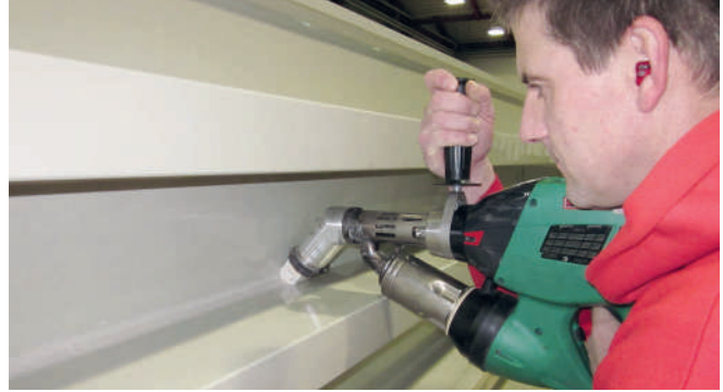
Угловой адаптер 45° для WELDPLAST S2 облегчает сварку в труднодоступных местах (принадлежность)
