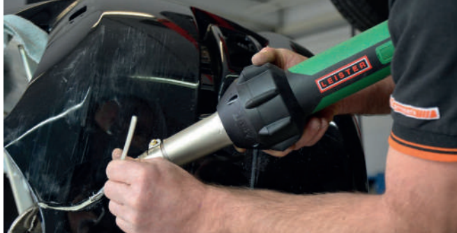
Ремонт автобампера с помощью ручного аппарата TRIAC ST
