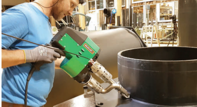
Мощный WELDPLAST S4 в работе
