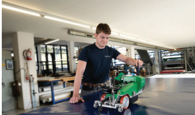
UNIPLAN 300 / UNIPLAN 500: идеально подходит для сварки внахлест, подворотов или рукавов
