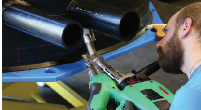
Новые угловые адаптеры 45 и 90° позволяют осуществлять сварку в труднодоступных местах
