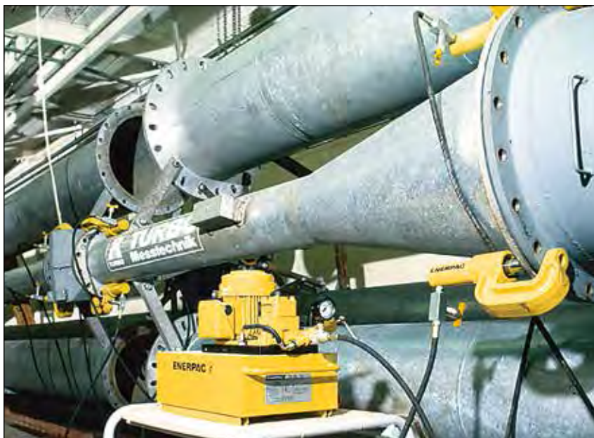
▲ Идеальный пример мощности и гибкости использования прессов с С-образной струбиной А-220 компании Enerpac.
