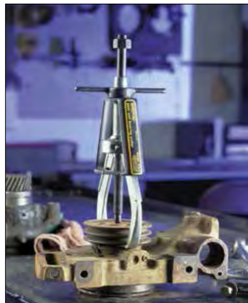
▲ Двухзахватный зажимной съемник EP-204, установленный для снятия ведущего шкива водяного насоса.
