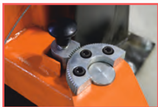
Автоматическая система блокировки положения лап при подъеме автомобиля.
