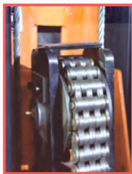
Усиленные подъемные элементы. Двойной шлейф приводной цепи.
