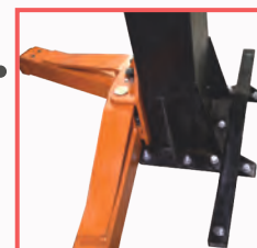
Опорная плита с усилителем и девятью точками крепления к полу.
