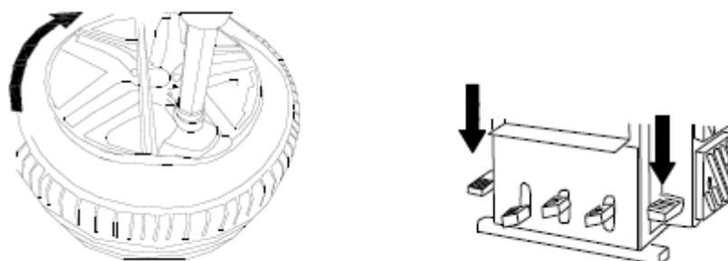
**Снятие нижней кромки с помощью монтажной головки**
