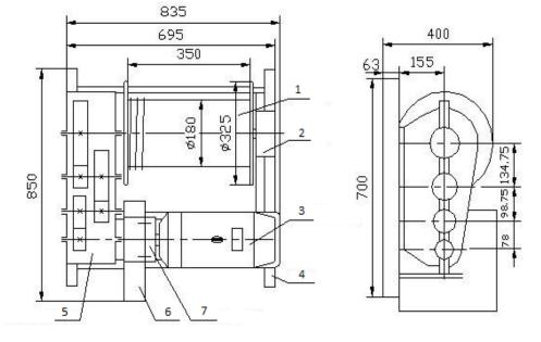
Рис.1. Общий вид лебедки электрической ЛМТ-1.0\*: 1- барабан, 2- опора выносная, 3- электродвигатель, 4- рама, 5- редуктор, 6- тормоз колодочный, 7- муфта, 8- пусковая аппаратура \*- все размеры указаны справочно и могут незначительно отличатся от действительных
