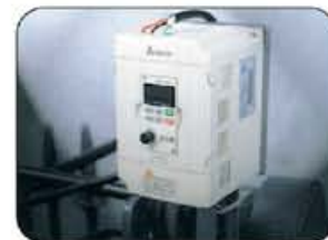
Регулировки осуществляются через частотный преобразователь (CT-D180S)
