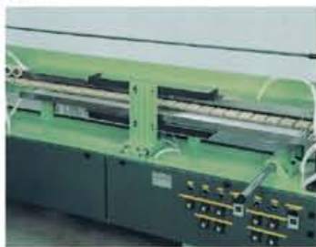
Узел нагрева и прижимной блок
