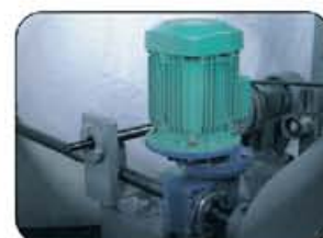
Двигатель корректировки скорости (CT-D180S)
