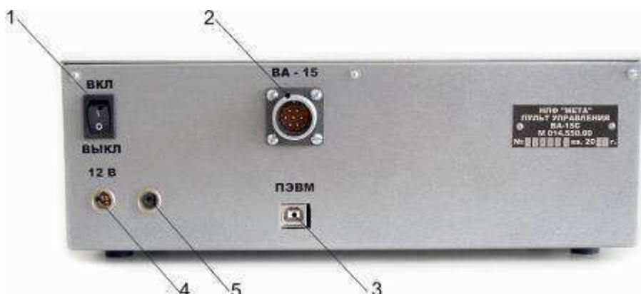
Рисунок 3а – Терминал управления весами. Вид спереди
