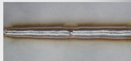
I-шов, CrNi t = 0,8 мм, воздушный зазор = 0,8 мм
