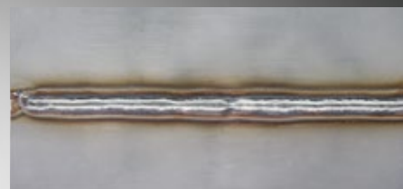
I-шов, CrNi t = 0,5 мм, без воздушного зазора
