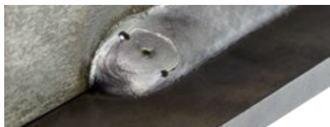
С завариванием концевых кратера – идеальное окончание шва
