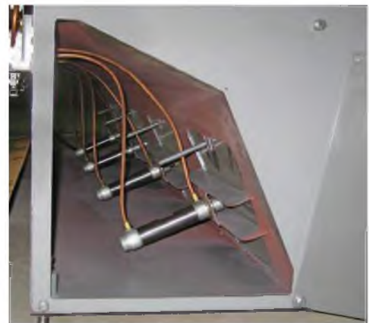
Пневмоцилиндры SMC (Япония) обвязываются только медными трубками
