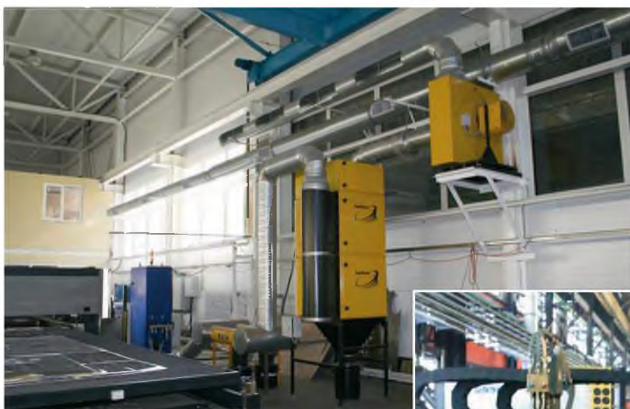
Пример монтажа фильтра MDB в комплекте с прямоточными циклонами ЦПО и вентилятором в шумопоглощающем кожухе FTEVnr
