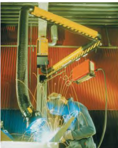
Вытяжное устройство, установленное на монтажной колонне.
