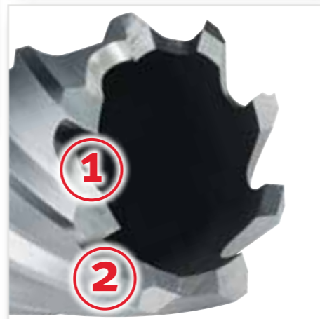
Высокая производительность зубьев благодаря черновым (1) и отделочным (2) резакам
