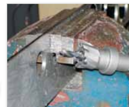
Ручное сверление до Ø 30 мм
