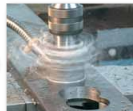
Сверление листовой стали с ровной поверхностью
