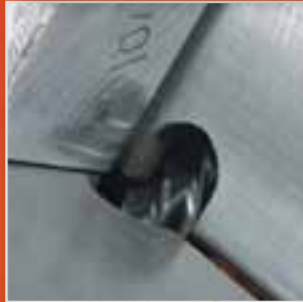
Точное снятие стружки благодаря самонастраивающейся фрезерной головке
