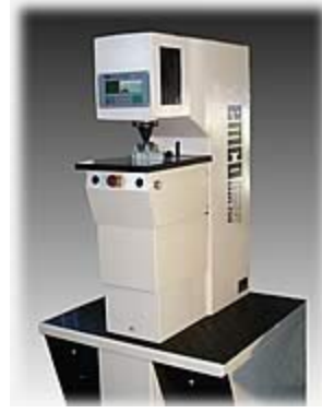
M4R250/750 Твердомер по Роквеллу с автоматическим столиком
