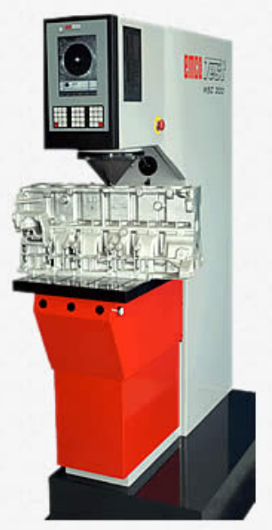
M5C 300 – автоматический столлик Нагрузки 20–3000кг (HBW 10/3000)
