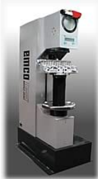
M5U 030 – ручной столлик Нагрузки 20–3000кг (HBW 10/3000)
