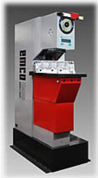
M5U 300 – автоматический столлик Нагрузки 20–3000кг (HBW 10/3000)
