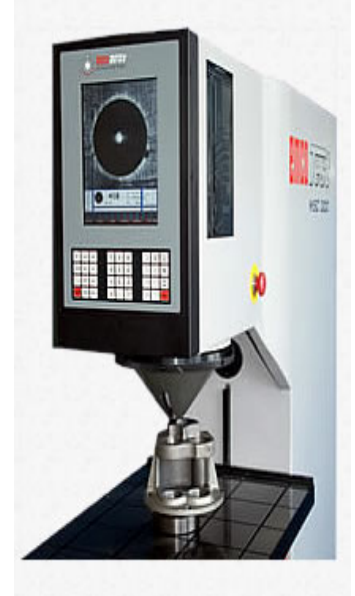
M5C 030 – ручной столлик Нагрузки 20–3000кг (HBW 10/3000)
