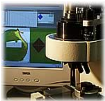
M4Z531 столик с ЧПУ X = 340 mm, Y = 120 mm Для серийных тестов
