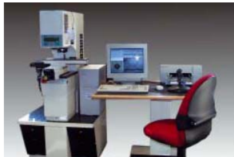
Автоматизированное место для измерения науглероженного и азотированного слоя.
