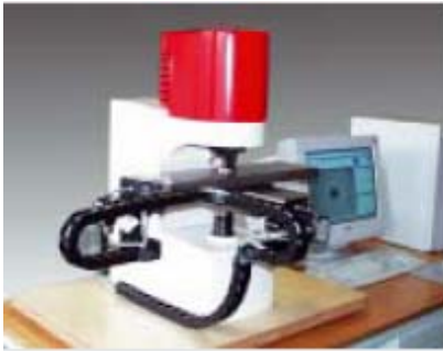
M4Z531 столик с ЧПУ X = 340 mm, Y = 120 mm Для серийных тестов
