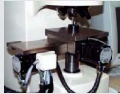
M1Z050 столик с ЧПУ X = 140mm, Y = 50mm Для Eht/Rht/Nht-измерений
