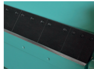
Sert Parçalı bıçaklar Hard Segmented Blades
