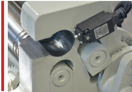
Opsiyonel Kafa Açma Sviçi Optional Drop-End Safety Switch
