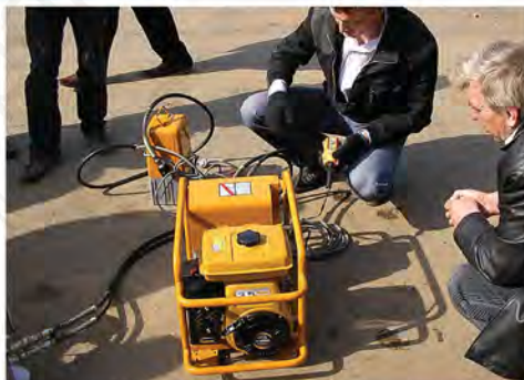
Насосная станция HPE-4
