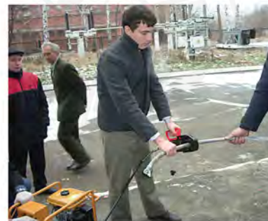
Универсальный резак SP-32. Провод АС-300/39
