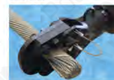
Резка сталеалюминиевого провода диаметром 40мм
