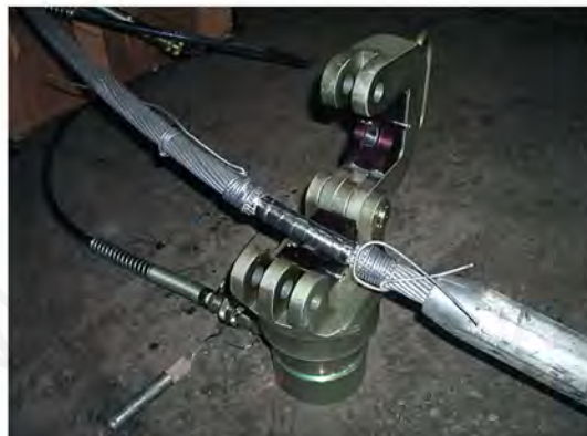
Пресс EP-520C. Опрессовка анкерного зажима соединителя САС-300-1.
