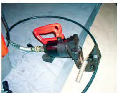
Резка арматуры диаметром 25 мм универсальным неавтономным резак SP-32
