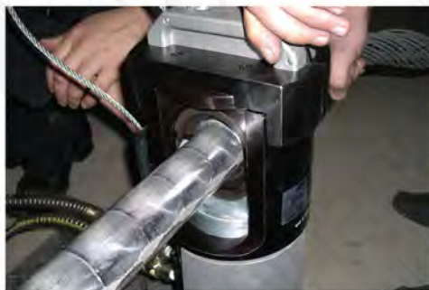
Пресс EP-60D. Опрессовка провода АС 300/39, зажим САС-300-1.
