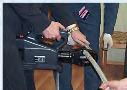
Резак REC-S3550G, провод АС 500/64
