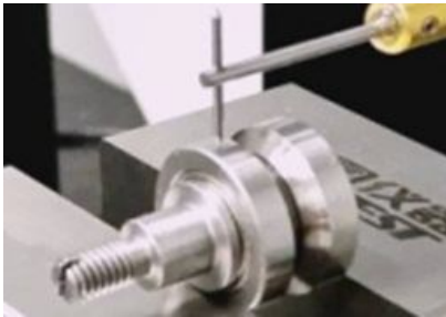
Измерение профиля детали
