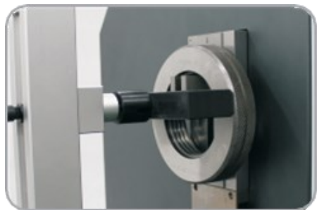
Измерение резьбового калибр-кольца
