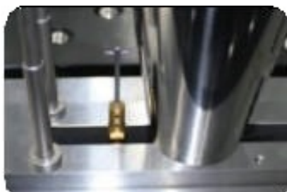
Измерение гладкой конусной калибр-пробки
