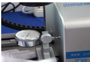
Проверка индикатора часового типа
