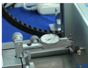
Проверка индикатора рычажного
