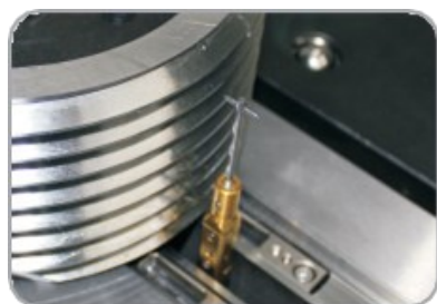
Измерение гладкой калибр-пробки
