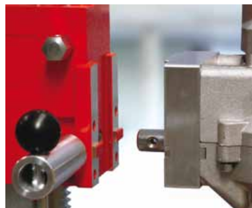
Система быстросъемного соединения Rapid-Lock - CARDI 200 / 250
