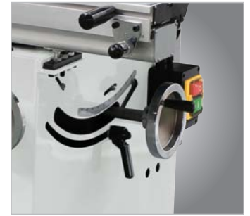
Handrad für Höhenverstellung des Sägeblatts
