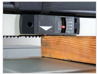
Mechanische Anzeige der Spanabnahme
