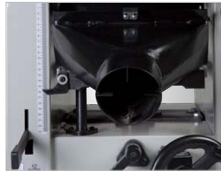
Dicktischverstellung über Handrad, Skala und numerischer Anzeige
