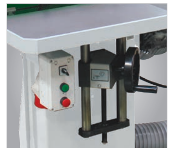
Höhenverstellbarer Schleiftisch zur Ausnutzung der gesamten Schleifbandbreite
