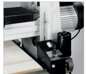
Höhenverstellung der Schleifeinheit an einer Skala ablesbar
