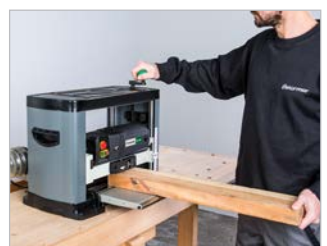
Höheneinstellung über Handkurbel und Skala
