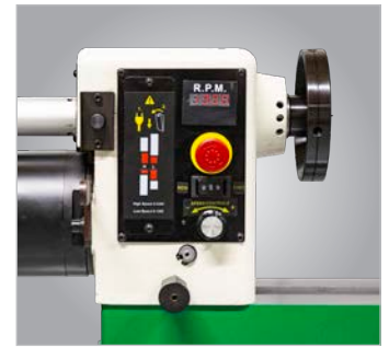
Digitalanzeige für Drehzahl integriert
