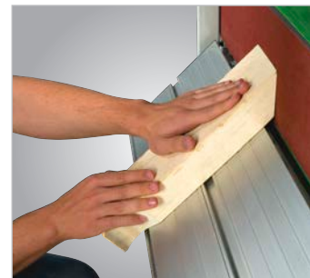
Gehrungen bis 45° durch Schwenken des Längstisches
