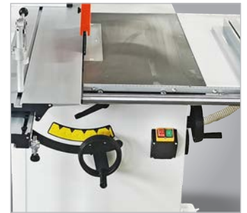
▶ Sägeblatthöhe und -schwenkung bequem über Handräder einstellbar
