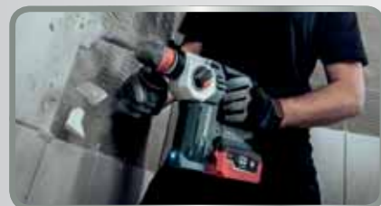
Комбинированный 3-х режимный перфоратор Бурение, сверление и долбление
