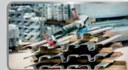
11 резов полос дорожного ограждения Материал: стальной лист
