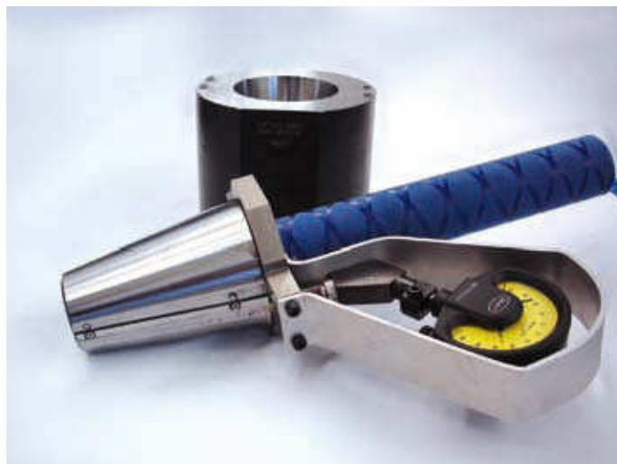
Коническое сопло-измерительное кольцо с коническим приспособлением
