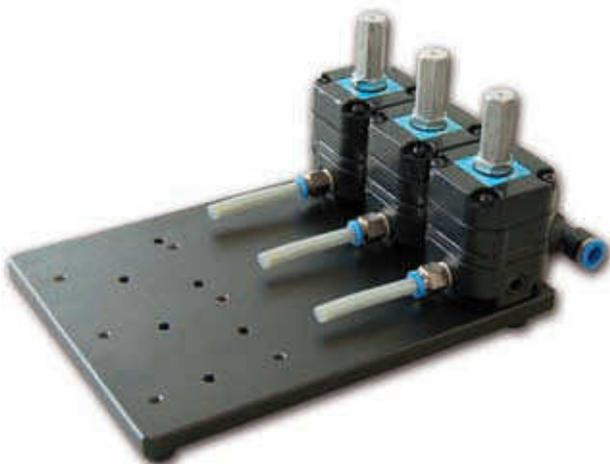
Этот модуль вырабатывает из давления воздуха прим. 5 бар, необходимое для эксплуатации пневмо-электронных преобразователей давление 2 бар. Так как это давление должно быть максимально постоянным, при эксплуатации пневмо-электронных преобразователей 1940 фирмы Mahr, предписано использование чувствительных редукционных клапанов.
