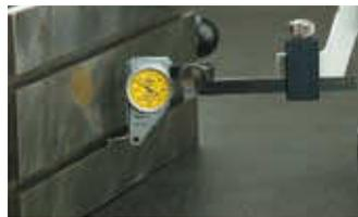
**Индикаторы рычажно-зубчатые MarTest боковые с метрической и дюймовой шкалами**
