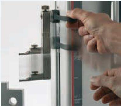
Рис. 1. Переместите измерительную каретку в направлении измеряемого объекта.
