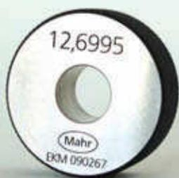
**Millimar 6105 установочное кольцо** для сопел-дорнов и контактных дорнов. Millimar-установочные кольца тщательно закалены, отшлифованы и отполированы. Качество N, производственный допуск JS3, допуск для цилиндричности 0,4 x числовое значение IT4.
