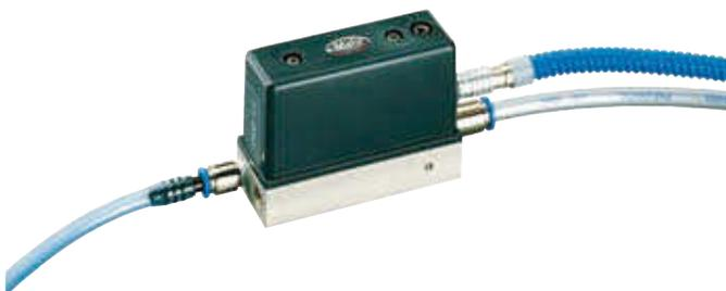
Пневмо-электронные преобразователи превращают сигнал пневматического измерительного средства (давление воздуха) в электрический сигнал. Благодаря пьезо-электрической системе, пневмо-электронный преобразователь X 1941 совместим с большинством имеющихся на рынке пневматических систем. На выходе Millimar X 1941 посылает аналоговый сигнал. Таким образом, пневмо-электронный преобразователь X 1941 достаточно легко подключается к компьютеру и элементам управления.
