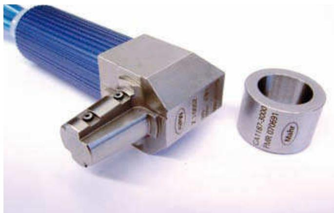
Конический пневматический измерительный дорн с подставкой
