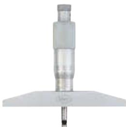
д) Микрометрическая головка
