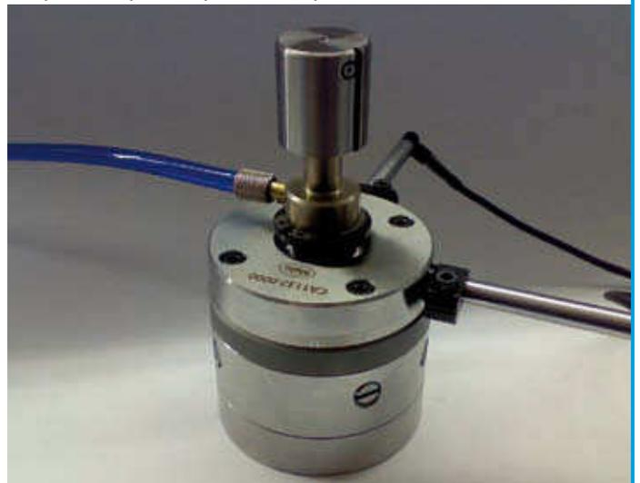
"Плавающее" сопло-измерительный дорн для определения диаметра и положения
