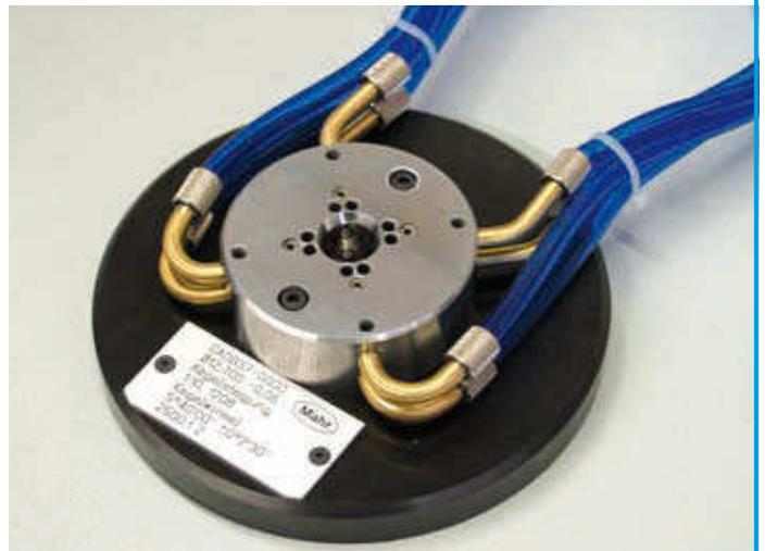
Коническое сопло-измерительное кольцо с парными измерителями в 2-х уровнях для проверки до 4-х  $\phi$ , 2-х углов конуса, 2-х уклонов конуса
